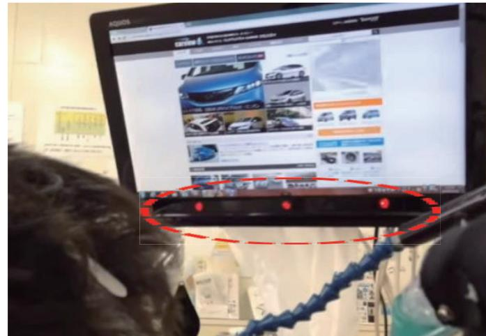
手足での操作が難しい場合に使用する機材です。高精度で視覚情報を取得することが可能で、目線で操作することができます。
