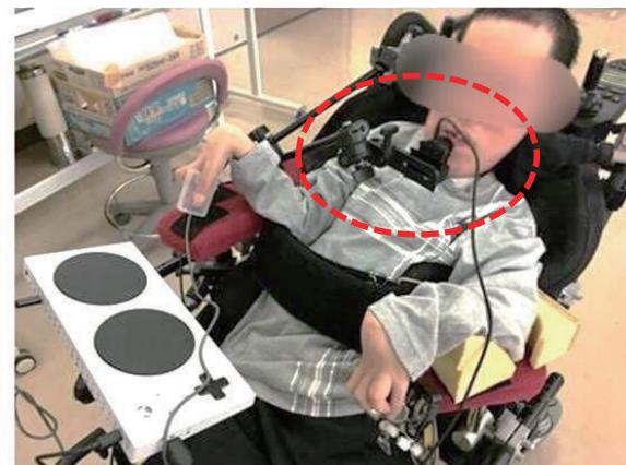
通常のコントローラーのアナログジョイスティックが硬くて押せない時や、手での操作が難しい場合に用います。
