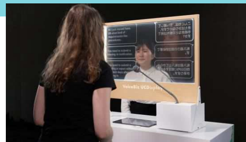
UC技術の例 (音声翻訳・文字化し、リアルタイムで透明ディスプレイに表示)
