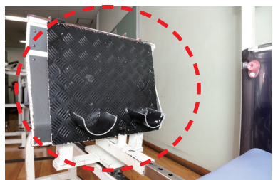
レッグプレスに、取り外し式の足置き台を設置して脚力をサポート
