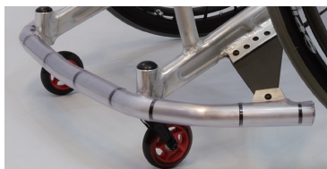
前方(床から11センチの位置)に足を保護する「バンパー」を取り付け、そこには同時に床に傷がつかないように保護材を設置しています。
